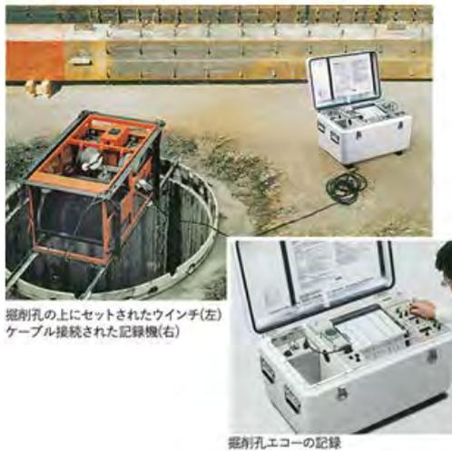
掘削孔の上にセットされたウインチ(左)
