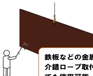
鉄板などの金属重量物の介錯ロープ取付け具としても使用可能。
