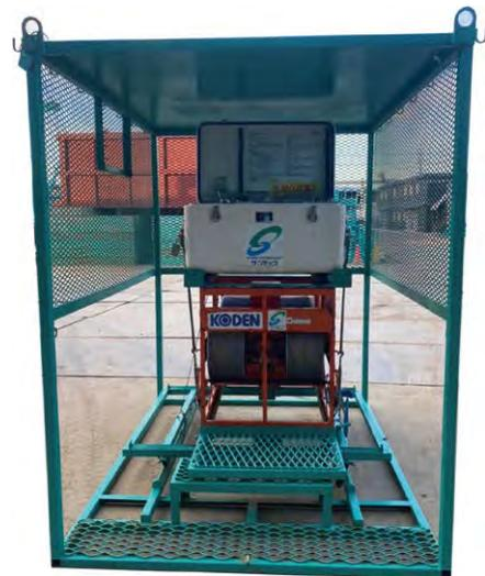
孔壁測定器用架台
